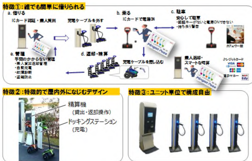
図 5 : Winglet シェアリングシステムの概要
